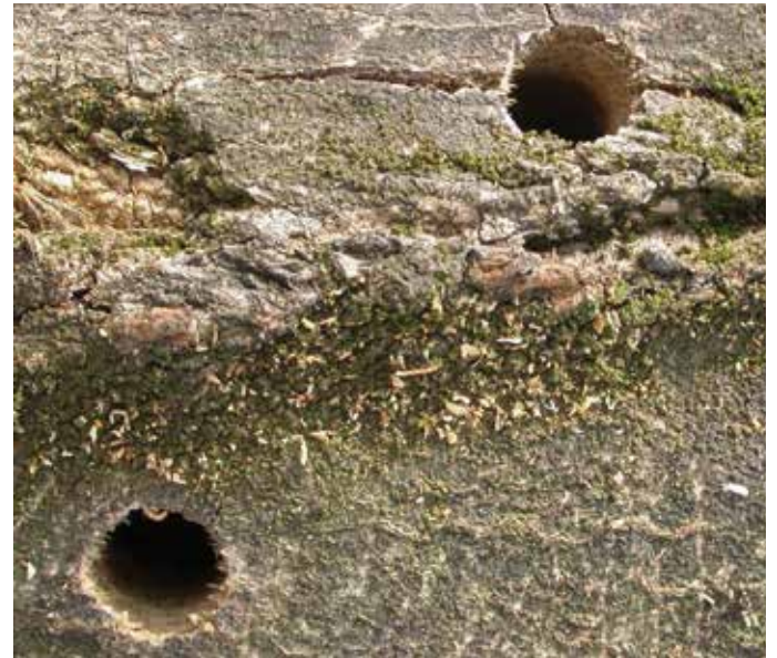
Kreisrunde Bohrlöcher (Durchmesser 1 - 1,5 cm)
