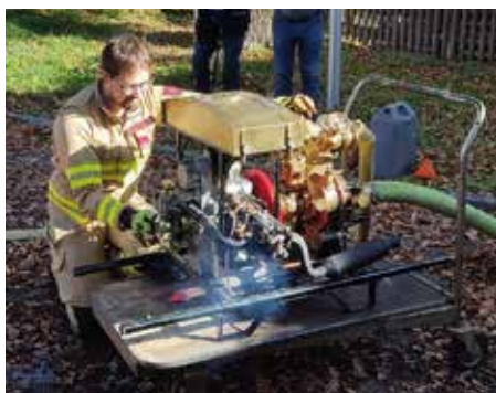
Obermaschinist Stefan Eibl bei der Bedienung der restaurierten Tragkraftspritze P48.
